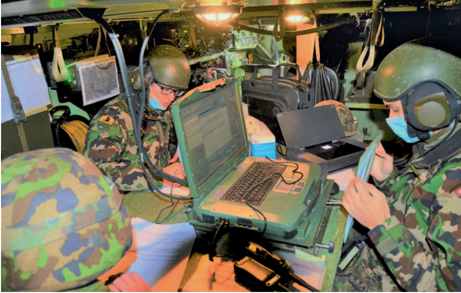
Blick in einen der beiden M-113 Spz des Abt Gefechtsstand Art Abt 10 – im Zentrum der INTAFF Feuerleitbildschirm. Bilder: Autor
